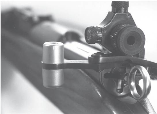
Bild 26: Linksriegel zu Karabiner 31
