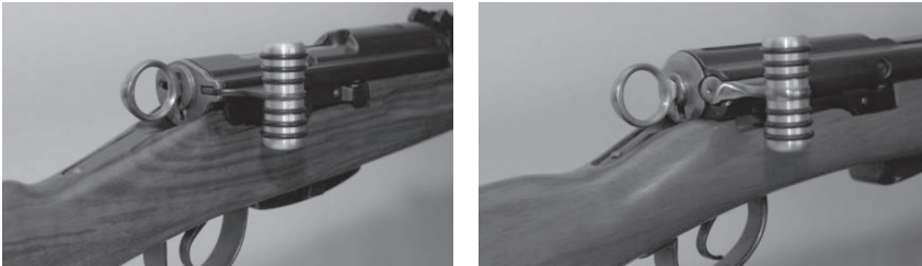
Bild 30: Riegelgriff anatomisch zu Karabiner und Langgewehr
