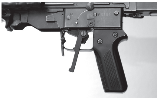
Bild 22: Winterabzug für Linksschützen zu Stgw 57
