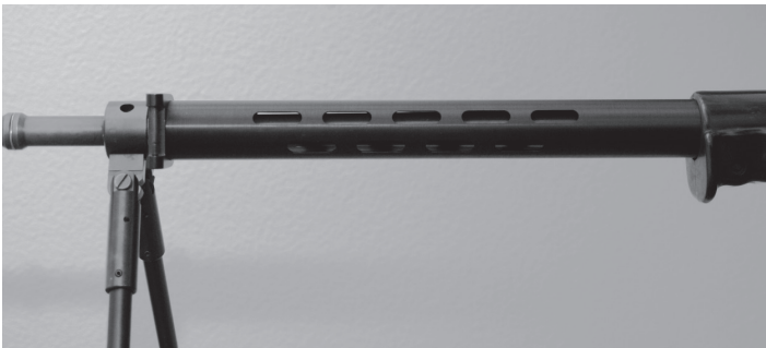
Bild 20: Mantelrohr zu Stgw 57
